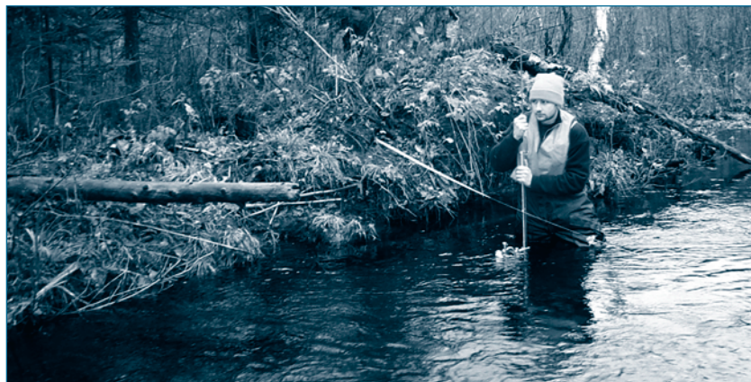
Mesure du débit d'eau dans une petite rivière près du bassin des lacs Turkey. Les relevés à long terme du débit d'eau et des autres paramètres physiques et chimiques permettent aux chercheurs de mesurer comment les écosystèmes boisés réagissent aux impacts humains tels que l'exploitation des forêts, les changements des niveaux de pollution et les fluctuations de climat à plus long terme.
