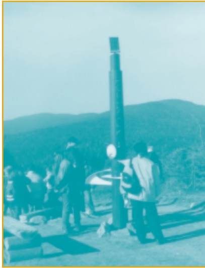
▲ Un petit module PV sert à alimenter une balise de piste le soir à Mont-Tremblant (Québec). Photo gracieuseté de TN Conseil inc.
