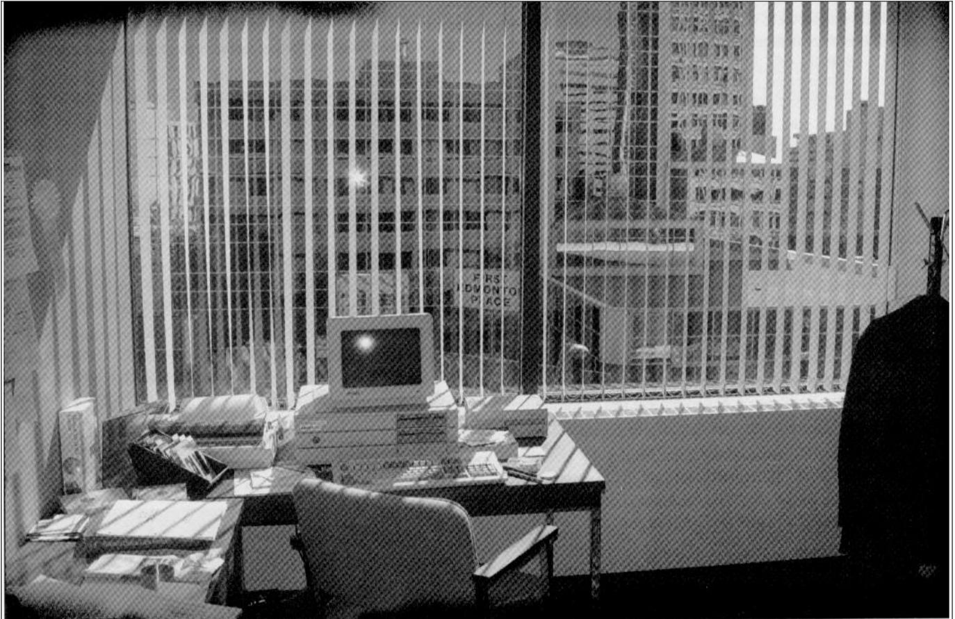
L'occupant de ce bureau faisant face à l'ouest se plaignait de la température l'après-midi. Il souffrait de maux de tête lorsqu'il travaillait pendant un certain temps à l'ordinateur. On a réduit la charge thermique et l'éblouissement (la cause des maux de tête) résultant de l'ensoleillement de l'après-midi, en installant des stores verticaux et en déplaçant le terminal de l'ordinateur.
