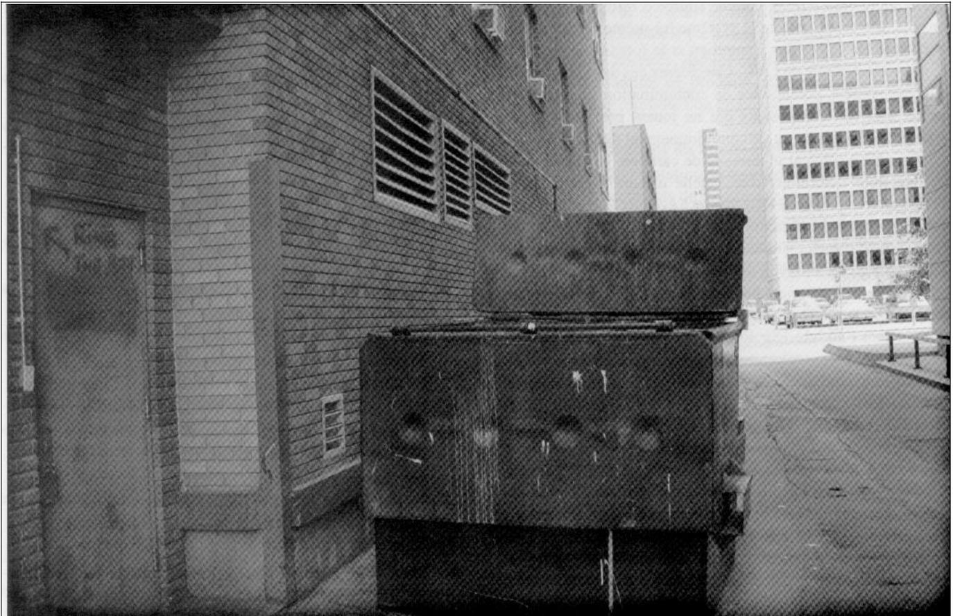
Souvent, les bacs à déchets et les prises d'air des édifices sont situés près du sol, dans des ruelles, pour des raisons d'ordre esthétique. Il peut en résulter des plaintes, à cause de l'entrée d'air «qui sent mauvais». Il suffit habituellement de déplacer le bac à déchets pour corriger le problème.
