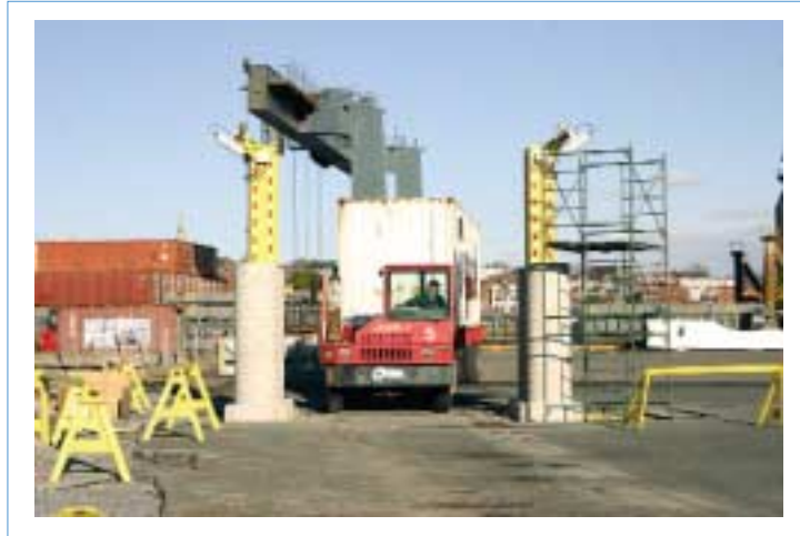
Un conteneur de fret est transporté par camion à travers un moniteur-portique.
