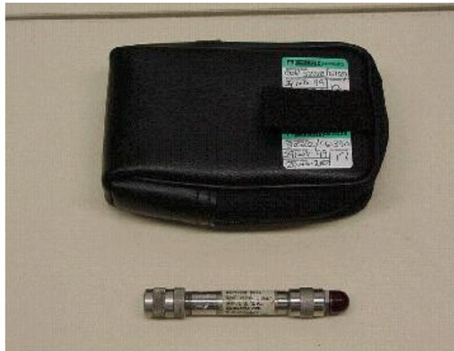
**Figure 1: Vérificateur de pointes aiguës typique**
