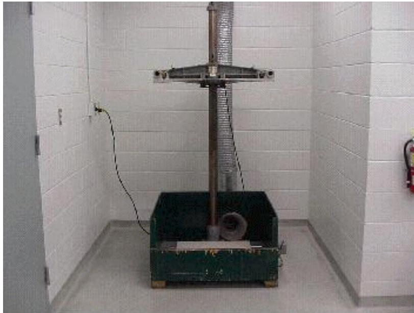
**Figure 1 : Appareil type d'essai de chute libre.**
