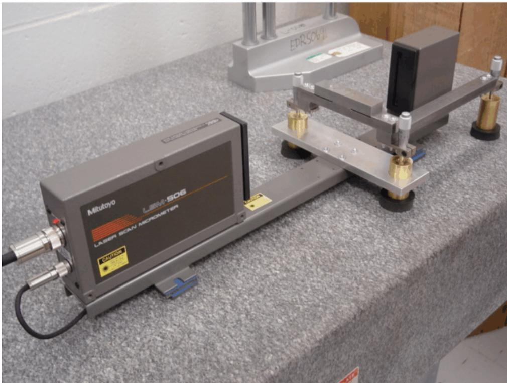
Micromètre à balayage laser (appareil de mesure de l'épaisseur)
