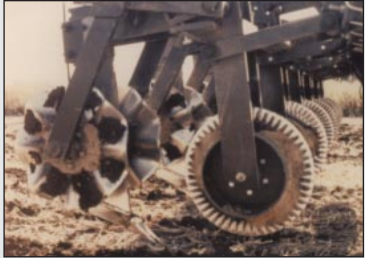
Cet instrument Trans-till MC fait partie d'une gamme d'outils conçus pour réduire le travail du sol tout en réduisant le compactage et en optimisant la croissance du maïs.
