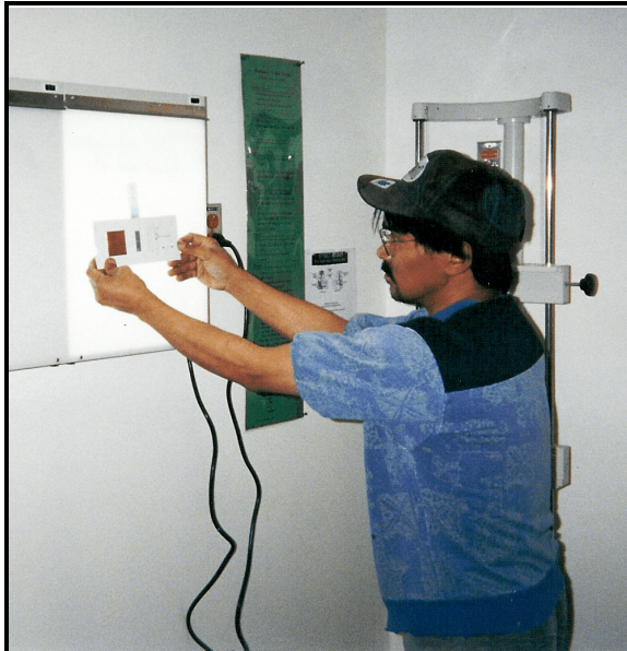
Figure 3: Noah Tassugat, travaille en radiographie au Clyde River Health Centre de Nunavut et utilise le testeur de contrôle de la qualité radiographique pour vérifier les appareils et les images produites.
