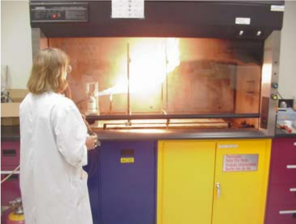
Tests sur la projection de la flamme et le retour de flamme des produits en aérosol
