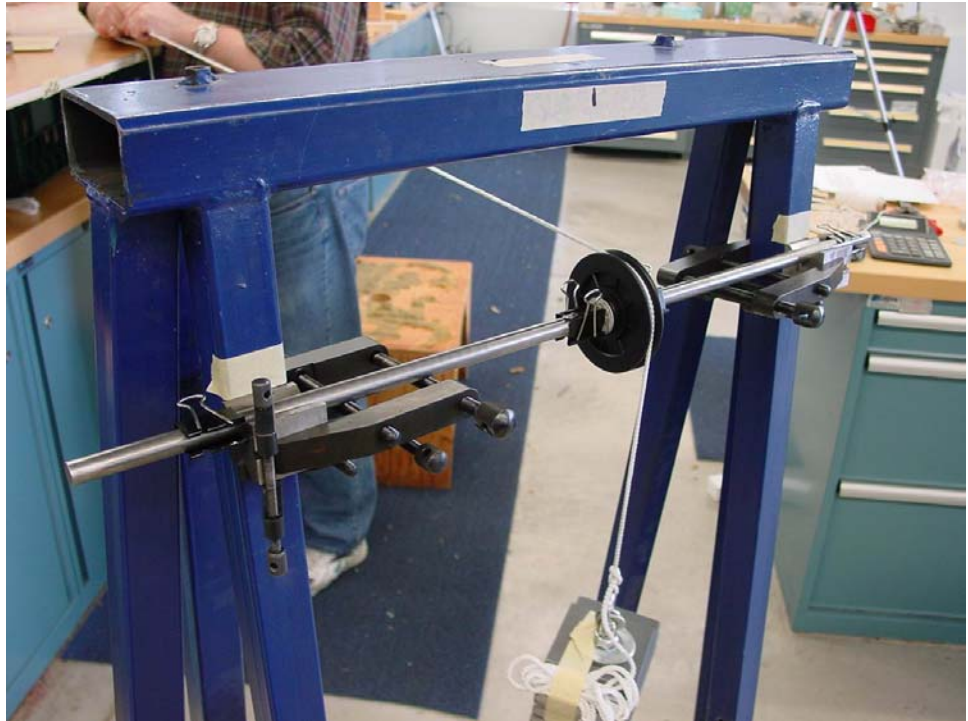
Figure 15 : Poulie installée pour les essais en angle
