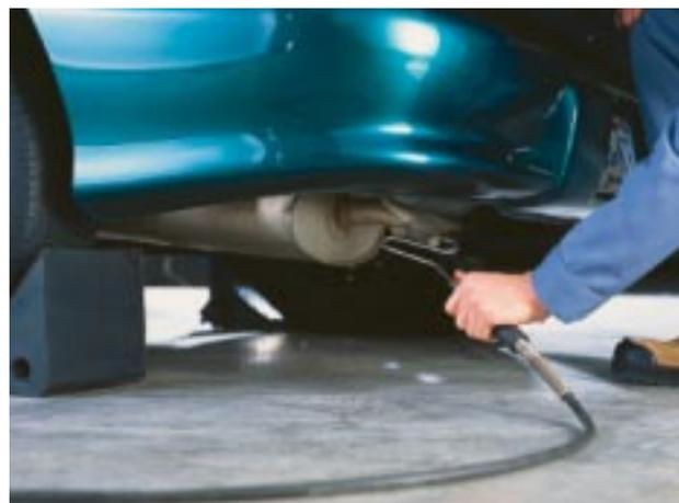
Un technicien spécialisé dans l'analyse des gaz d'échappement pose le véhicule sur un dynamomètre, c'est-à-dire une sorte de tapis roulant qui fait tourner les roues sur place. Un capteur, relié à un analyseur de gaz et à un ordinateur, est inséré dans le tuyau d'échappement. Le dispositif mesure les concentrations d'oxydes d'azote (NO<sub>x</sub>), de monoxyde de carbone (CO) et d'hydrocarbures (HC), qui sont des composés organiques volatils (COV).
