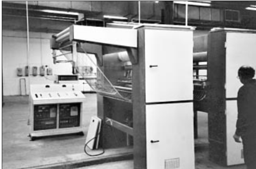
Essoreuse à deux foulards
