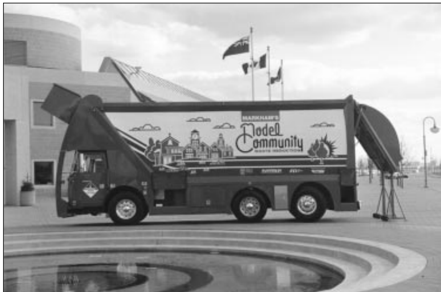
Le camion à ordures de Fiba Canning équipé du système de récupération de l'énergie de freinage
