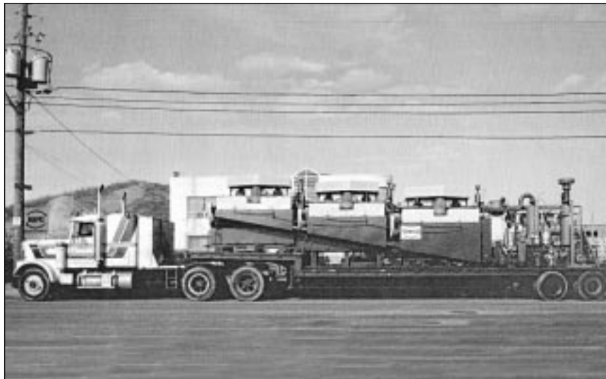
Unité semi-mobile pouvant traiter 50 tonnes de sol par jour
