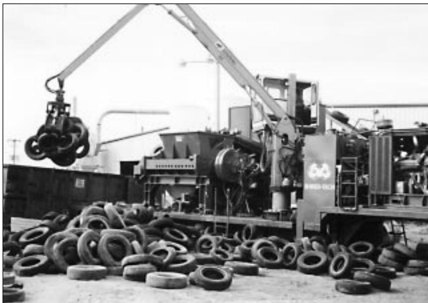
Système mobile de déchiquetage de pneumatiques de Shred-Tech
