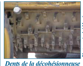
Dents de la décohésionneuse qui servent à désagréger l'asphalte existante.
