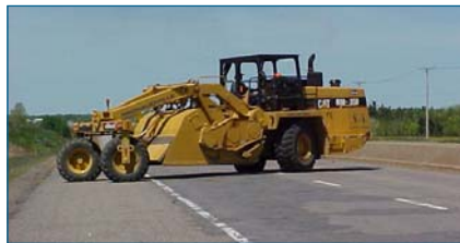
Machinerie qui sert à décohésionner, communément appelée décohésionneuse.
