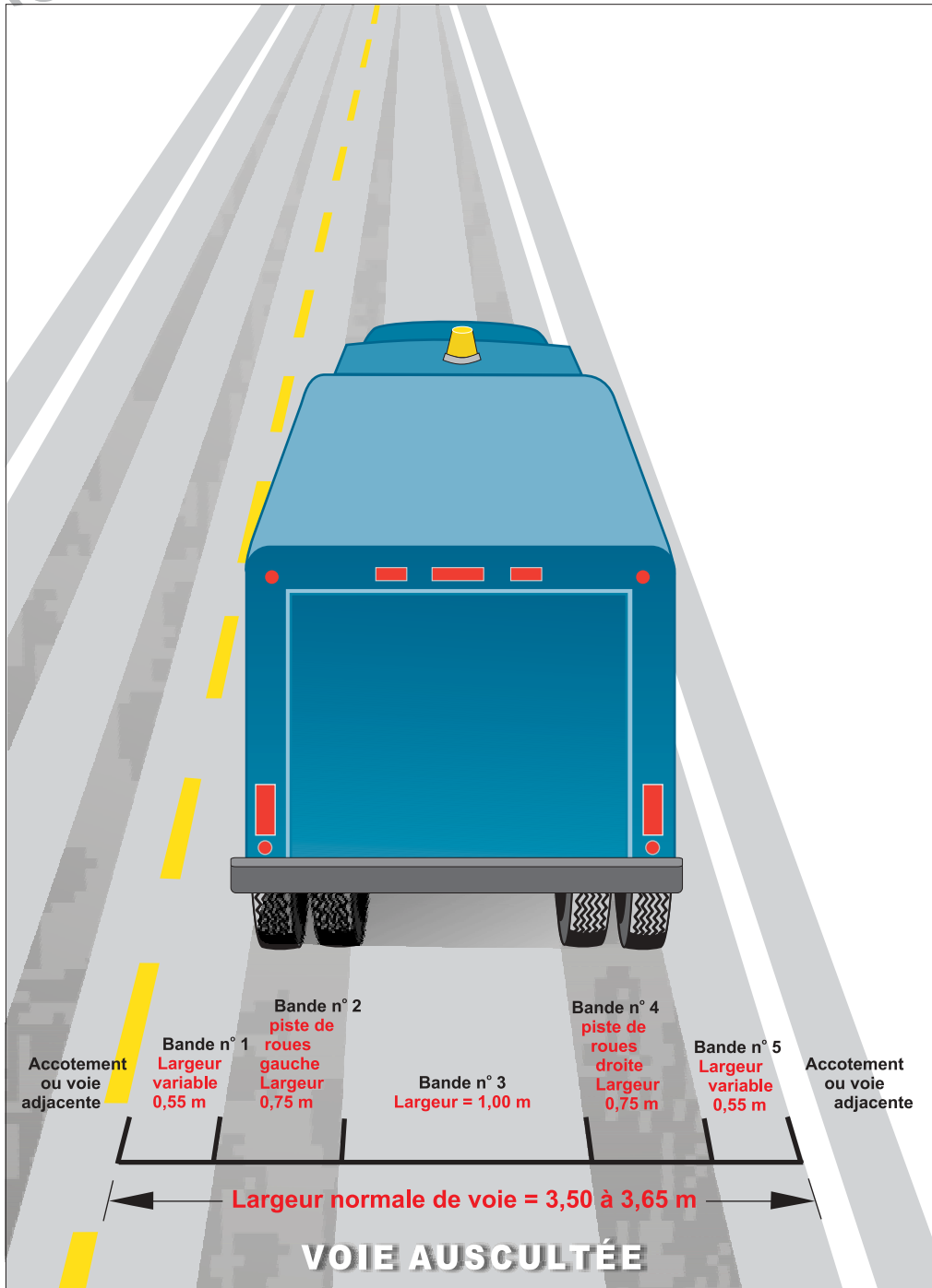
Figure 1-1 Détails des bandes d'auscultation pour la fissuration
