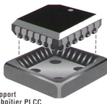
Boîtier PLCC (boîtier plastique avec broches en J)
