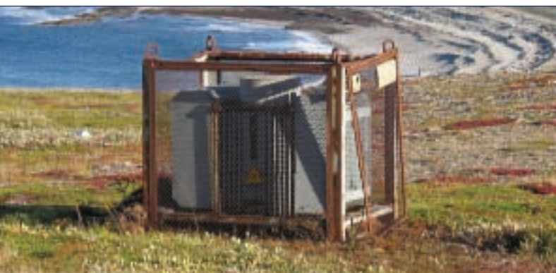
Высокорadioактивные материалы, которые могут быть использованы для изготовления «грязной бомбы», служат топливом для российских маяков. Фотография предоставлена губернатором провинции Финмаркен (Норвегия)
