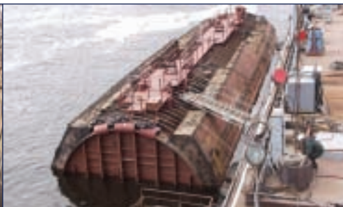
Трехотсечный реакторный блок
