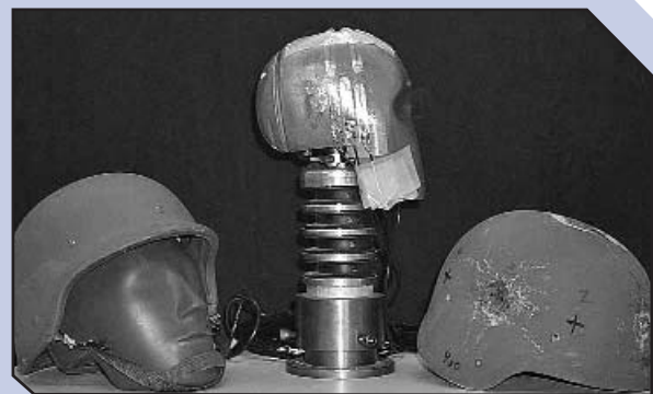
Équipement d'essais balistiques et casques utilisés pour créer une nouvelle norme de protection
