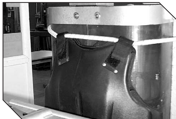
Essai de gilet de protection utilisé par les policiers en cas d'émeute.
