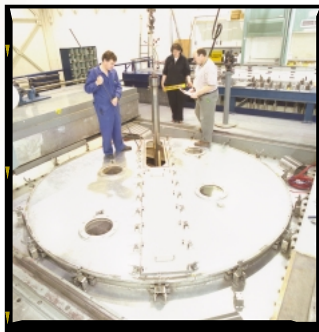
Le personnel du service Physique du réacteur et des rayonnements installe un «canal chaud» dans le ZED-2 qui permet de prendre des mesures de physique du réacteur à des pressions et à des températures similaires à celles d'un réacteur de puissance CANDU en exploitation. Les mesures serviront à valider la boîte à outils physique.
