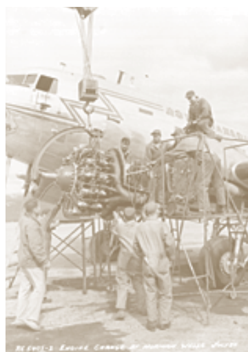
Changement de moteur d'un Dakota d'une escadrille de photographie aérienne, au camp de Norman Wells (T.N.-O.), juillet 1950. Des équipages au sol, les cuisiniers y compris, se joignaient aux équipages habituels des avions de Rockcliffe se rendant aux bases du Nord. (Archives nationales du Canada PA 66428)
