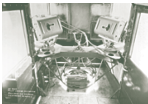
Installation de caméras aériennes dans la cabine d'un Bellanca Pacemaker de l'ARC, Rockcliffe, 1935. (Archives nationales du Canada PA 63078)
