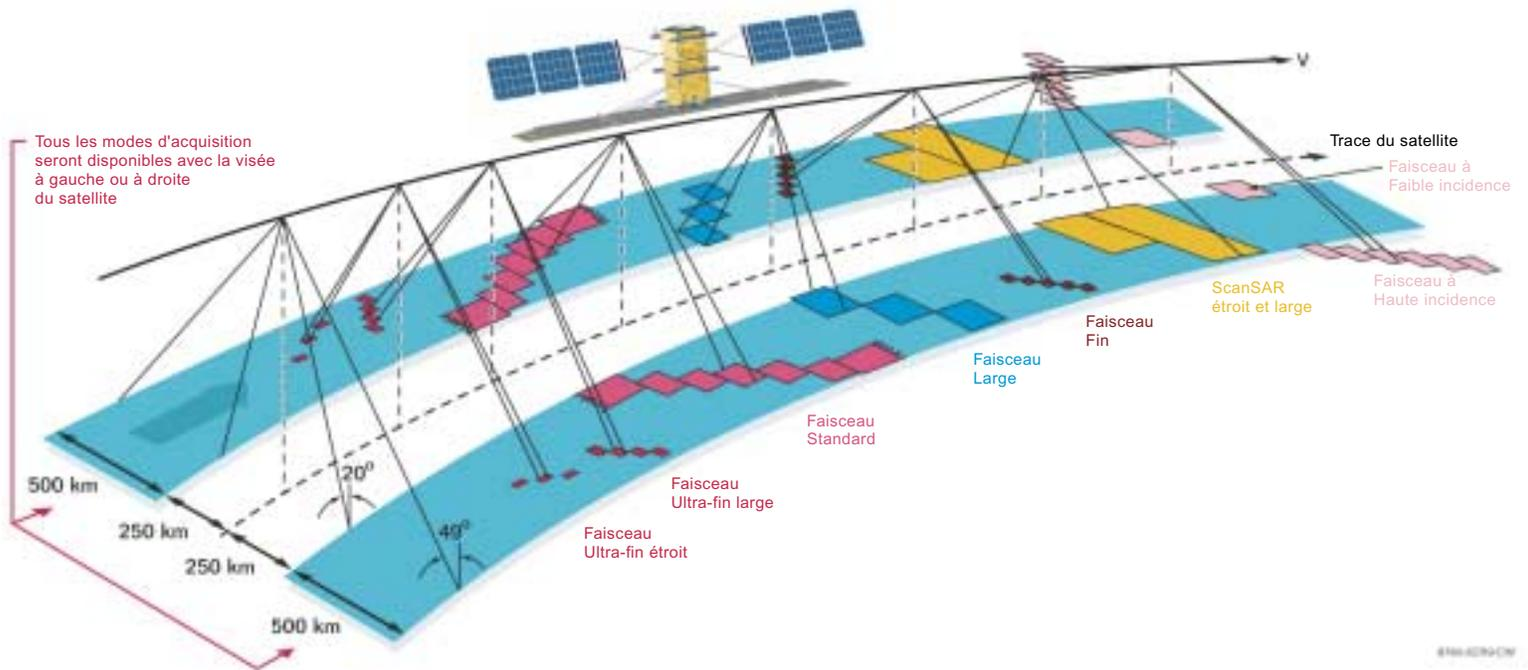
Équipé d'une antenne RSO en bande-C (5,4 GHz), RADARSAT-2 assure la continuité de tous les modes d'acquisition de RADARSAT-1 tout en offrant de nouvelles capacités allant d'améliorations majeures de la résolution spatiale à une diversité de sélections de polarisation. (© MDA)
