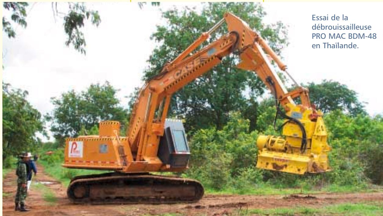
Essai de la débroussailleuse PRO MAC BDM-48 en Thaïlande.
