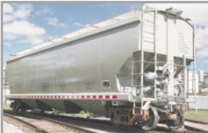
*Les wagons-trémies couverts ont une capacité cubique optimale qui permet d'accroître l'efficacité du transport de produits comme la potasse, les grains ou le sel.*
