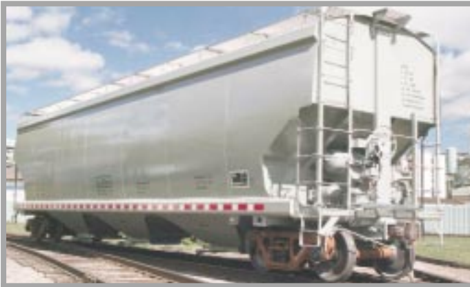
Os vagões tremonha cobertos possuem uma capacidade cúbica otimizada, permitindo aumentar a eficiência do transporte de produtos como » a potassa, os grãos ou o sal. (Foto: National Steel Car Ltd.)
