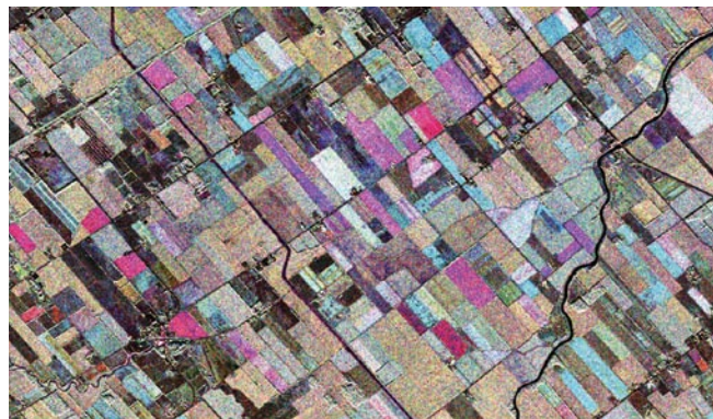
Image composite multipolarisée de champs agricoles au sud d'Ottawa captée par le CV-580 C/X-SAR. Les multiples modes de polarisation, angles d'incidence et résolutions spatiales offerts par RADARSAT-2 permettent de fournir de précieuses informations pour la gestion agricole (notamment l'identification des cultures, la conservation des sols et la détermination de l'humidité des sols). (Image : CCT, 1998)
