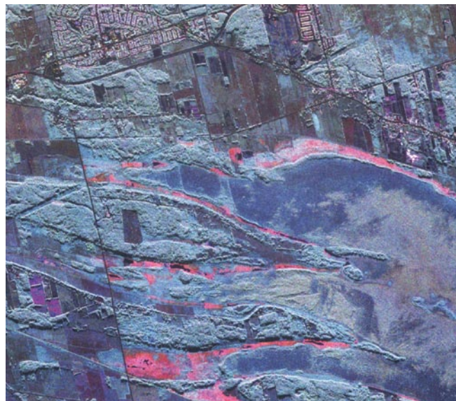
Comme en témoigne cette image composite multipolarisée de la tourbière de la mer Bleue captée au moyen du CV-580 C/X-SAR, la polarisation multiple permet de distinguer facilement les terres émergées et d'identifier avec précision les caractéristiques cartographiques. Il est également possible d'extraire des informations sur la distribution spatiale et l'évolution temporelle de l'occupation des sols et de la couverture terrestre. (Image : CCT, 1995)
