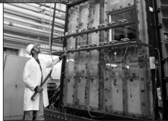
Préparation d'ensembles mur-fenêtre en vue d'essais sur la pénétration de l'eau exécutés dans l'installation d'essais dynamiques de murs (IEDM) de l'IRC-CNRC
