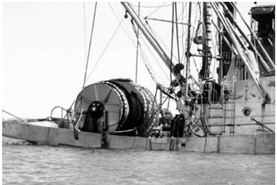
Le pont de pêche du Cap Rouge II, avec la senne à saumon « côte ouest » enroulée sur son tambour
