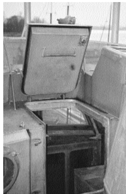
Panneau combiné à une porte sur penture placé sur l'arrière de la timonerie dans l'axe longitudinal
