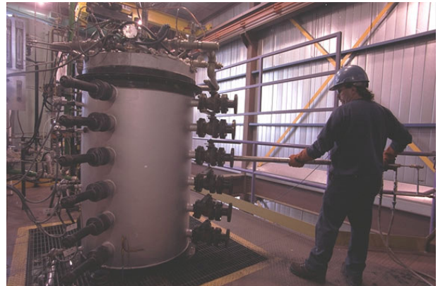
Un membre du GPEE effectue des mesures de la température dans le système vertical de combustion.
