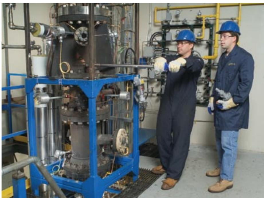
*Le CTEC – Ottawa est muni d'une gamme variée d'installations et de techniques permettant de répondre aux besoins industriels et commerciaux, comme ce gazogène à hautes pressions aboutissant à des gaz synthétiques pour l'obtention d'hydrogène et la production d'électricité par alimentation au charbon écologique.*
