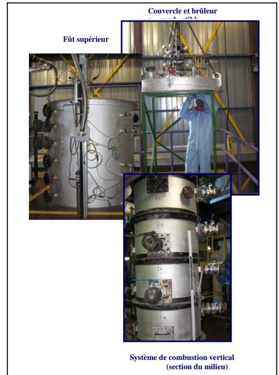
Système vertical de combustion des oxy-combustibles à l'échelle préindustrielle des installations de recherche du CTEC-Ottawa
