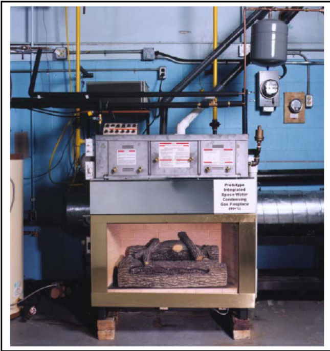
Prototype de foyer à condensation, alimenté au gaz, pour le chauffage d'espace et d'eau
