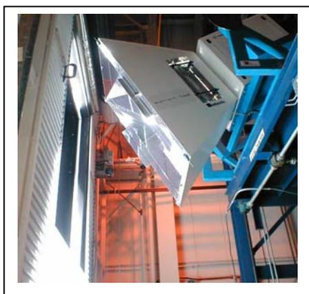
*Le simulateur solaire intérieur Vortek de 200 kW installé au Centre national d'essais d'équipements solaires de Mississauga, en Ontario.*
