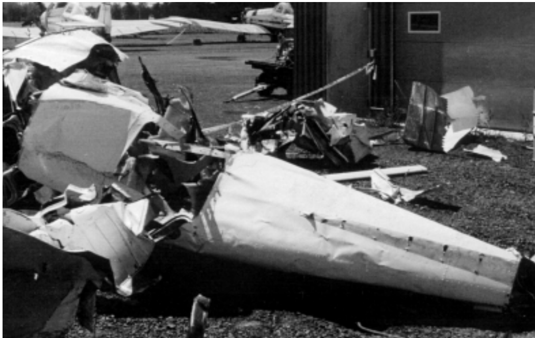
Surface supérieure du fuselage. La dérive de l'avion s'est détachée en vol.
