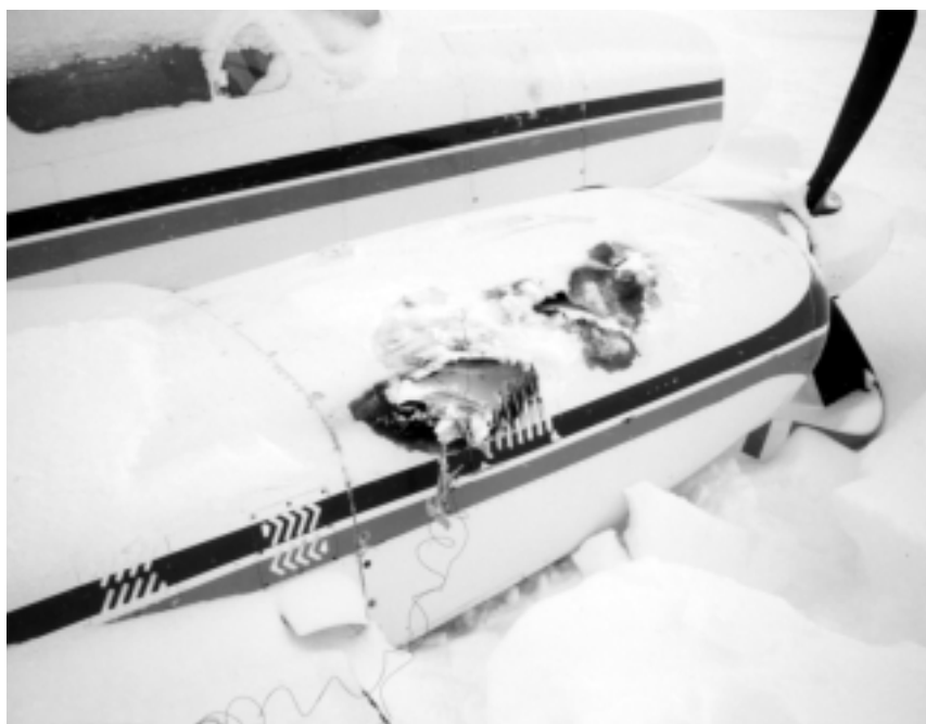
Des modifications non conformes aux normes apportées à l'installation de chauffage de la cabine sont à l'origine de l'incendie moteur qui s'est déclaré après le décollage.
