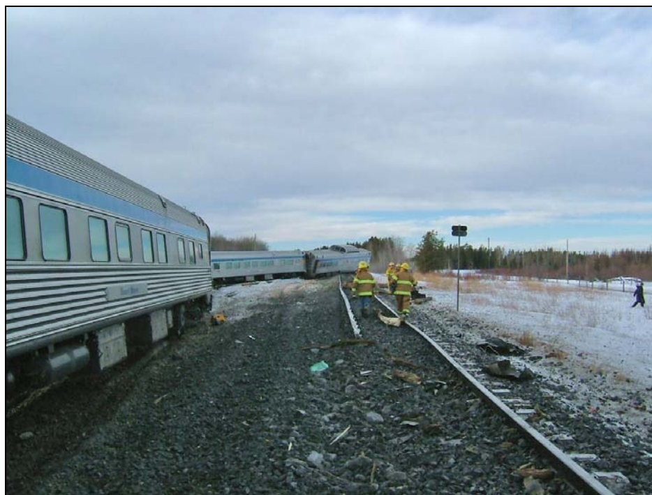
Photo 2. Vue en direction est, à partir du passage à niveau, du déraillement et des dommages causés à la voie ferrée
