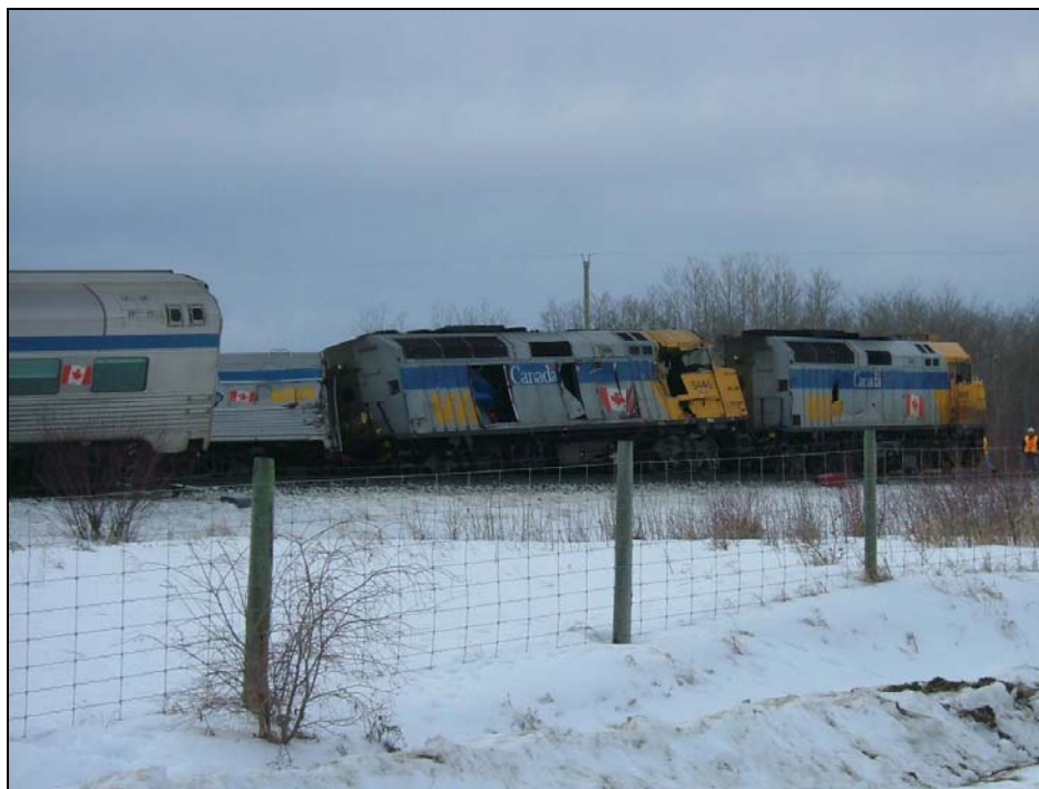
Photo 3. Vue des dommages causés au côté nord des deux locomotives
