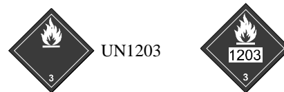
L'illustration du numéro UN à droite de la plaque n'est qu'un exemple et n'indique pas le placement obligatoire. Une étiquette enveloppante peut être utilisée sur une bouteille à gaz.
