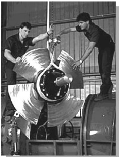
Petite turbine hydroélectrique en cours de fabrication.
