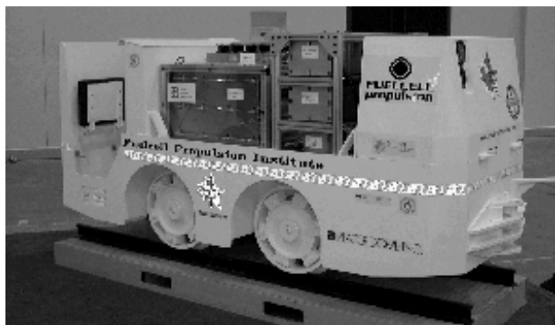
Locomotive minière construite au Canada - le premier véhicule industriel au monde mû par une pile à combustible.
