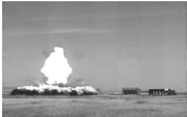
Des fenêtres montées dans des structures (à droite) sont soumises à des essais de résistance aux explosifs.
