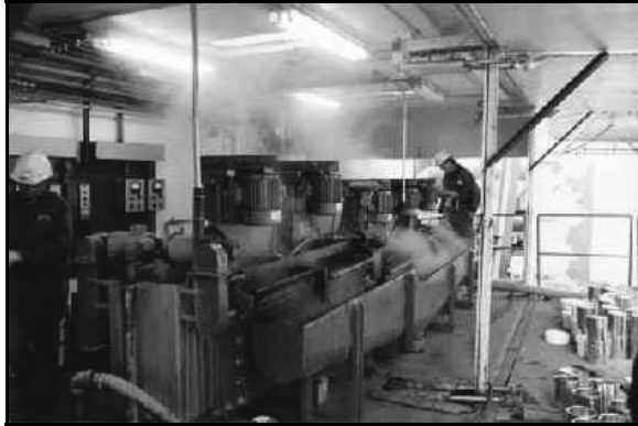
Récupération du bitume à partir de résidus
