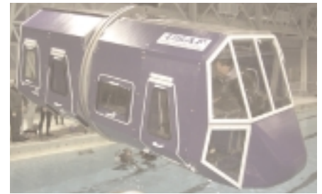
Un simulateur modulaire d'entraînement à l'évacuation (METSMC) de Survival Systems.
