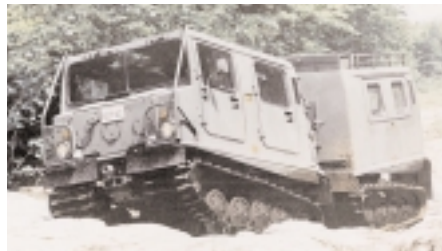
Le véhicule BV 206 de la Défense nationale canadienne, muni du système Soucytrack.
