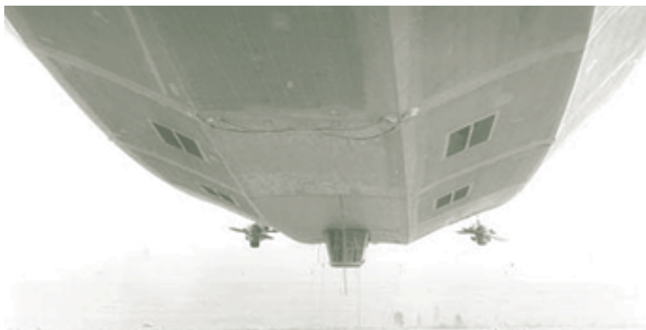
La nacelle de commandement du R.100
