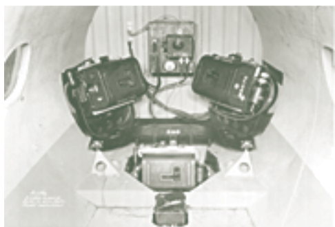
Installation multicaméra dans la cabine d'un Fairchild Super 71 de l'ARC, Rockcliffe, 1936. (Archives nationales du Canada PA 63181)
