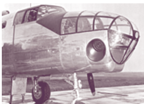
Installation de caméras utilisées par le procédé trimétrigone de cartographie à bord d'un B-25 Mitchell, 1944. (Archives nationales du Canada PA 65503)
