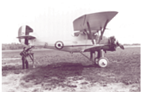
Un Siskin III en position de vol aux fins de réglage, à la suite d'une révision en 1931 par l'Ottawa Car Manufacturing. Les Siskin étaient utilisés pour la formation en voltige qui faisait partie intégrante de l'entraînement des pilotes de l'ARC. (Archives nationales du Canada PA 62726)
