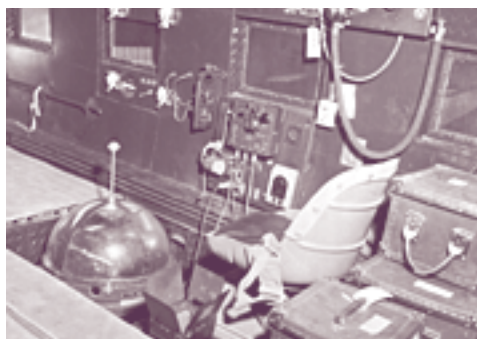
Installation de caméras dans un Dakota de l'ARC, 1950. (Archives nationales du Canada PA 66320)
