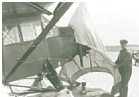
Réchauffement du moteur d'un Fairchild FC-2 avec une torche et une couverture de toile pour le moteur, mars 1929. (Archives nationales du Canada PA 62629)
