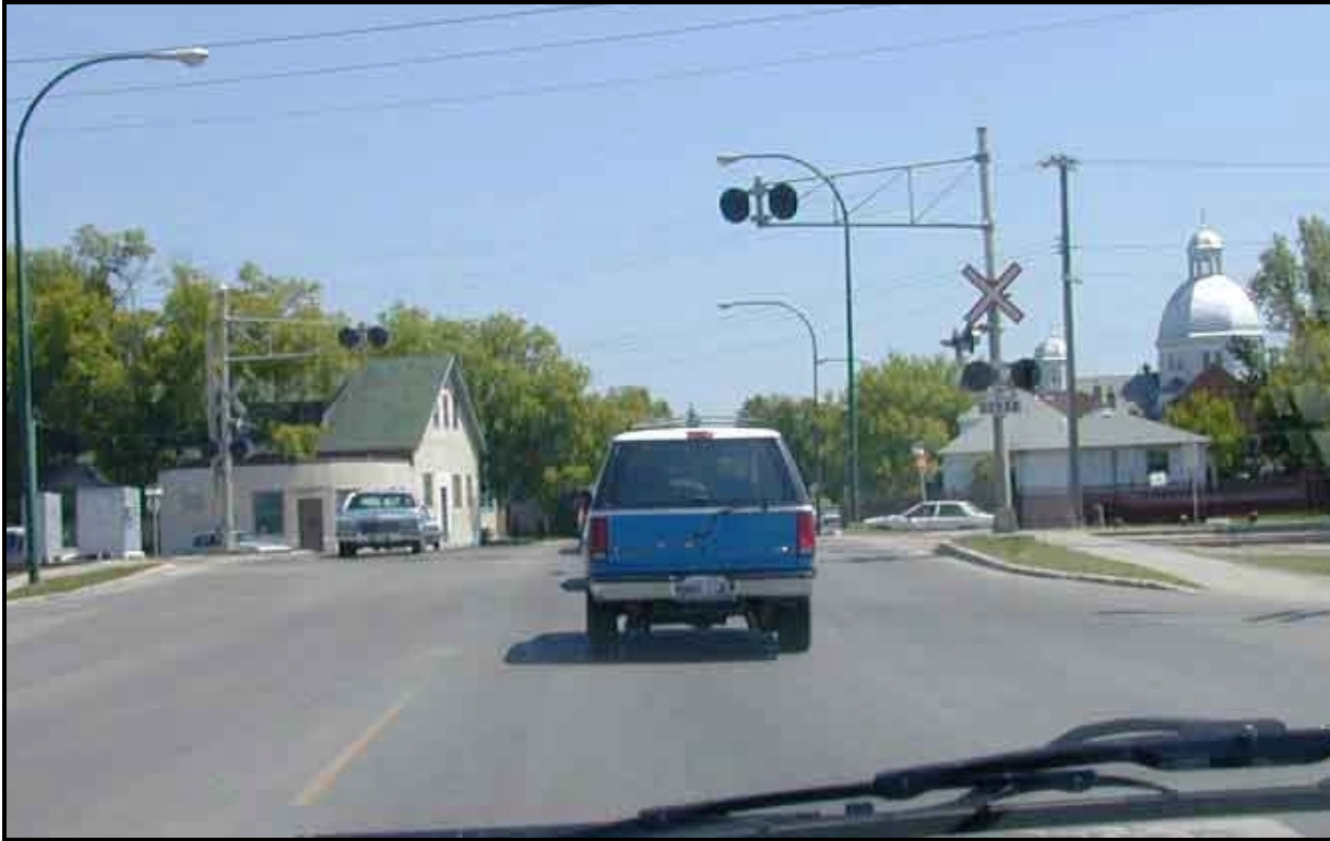
Figure 2.2 Croix d'avertissement, feux fixés à un poteau et en porte-à-faux au-dessus de la route, panneau indicateur de double voie et lampadaires dans une banlieue de Winnipeg
