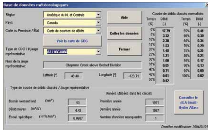
Figure 29 : Exemple de données hydrologiques d'Environnement Canada pour plus de 500 jauges de rivières canadiennes disponibles à même le modèle RETScreen pour projets de petites centrales hydroélectriques.
