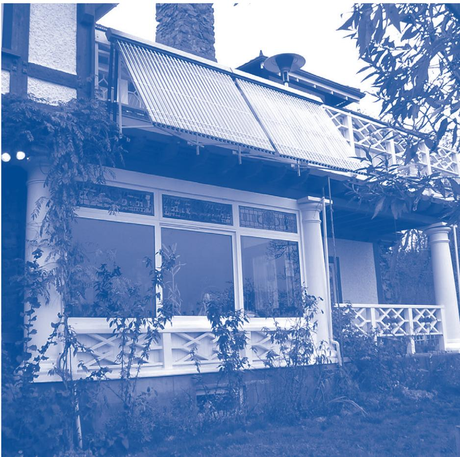
*Les panneaux solaires sont utilisés pour chauffer l'eau des maisons.*
