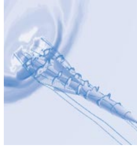
Simulation par CFD de l'écoulement sur un missile montrant les tourbillons provenant du corps et des ailes.
