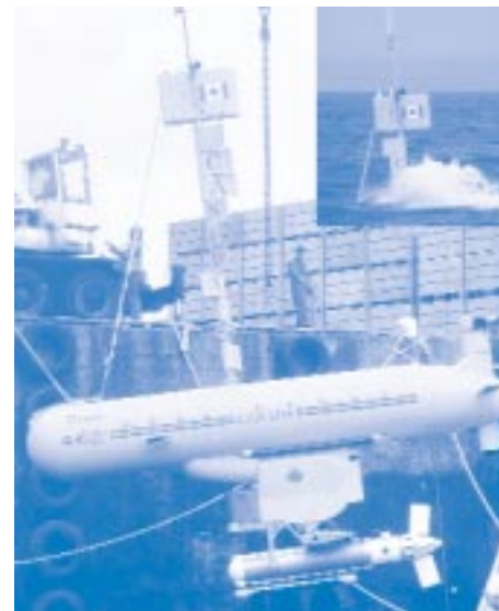
Le véhicule semi-submersible autonome Dorado lors d'une démonstration comme chasseur de mines pour la marine française.
