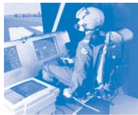
Le cockpit de démonstration permet d'effectuer un prototypage virtuel des instruments de bord, ce qui facilite les évaluations des facteurs humains.
