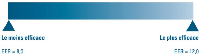
Bien que les appareils à haut rendement énergétique coûtent plus cher à fabriquer, cela ne se reflète pas nécessairement dans le prix de vente au détail. On doit choisir un appareil qui affiche le meilleur EER possible pour réduire au minimum les coûts d'utilisation.
