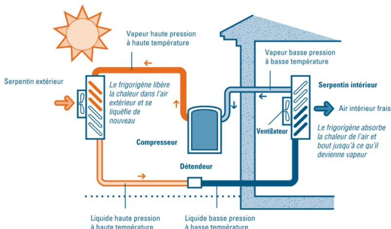
Selon le cycle à compression, le fluide frigorigène passe à travers le détendeur, transformant ainsi le liquide en un mélange liquide basse pression et gaz. Dans le serpentin intérieur ou évaporateur, le liquide excédentaire absorbe la chaleur de l'air intérieur de la maison et devient un gaz à basse température.
