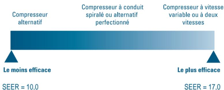
Les compresseurs alternatifs perfectionnés, les compresseurs à conduit spiralé et les compresseurs à deux vitesses ou à vitesse variable couplés aux meilleurs échangeurs de chaleur et commandes permettent d'obtenir un SEER atteignant 17,0 (voir la figure 8). Les appareils de climatisation centrale dont le SEER est le plus élevé sont tous équipés de compresseurs haut rendement à vitesse variable ou à deux vitesses.
